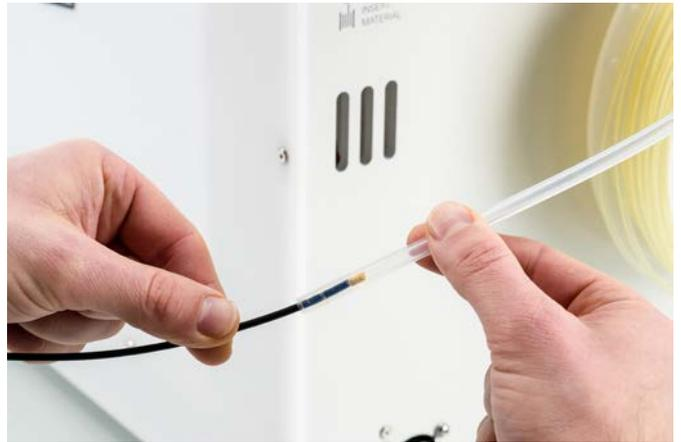
7. 按住進料器的合夾頭並完全推入送料管，以將送料管插入進料器。用夾片固定送料管。對另一根送料管重複此步驟。
