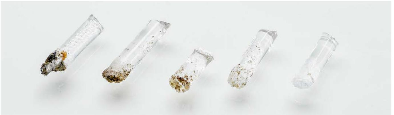
5. 重複此程序，直至清潔線材的尖端上再也看不到降解的材料。線材的尖端應該看起來和右側範例一樣乾淨。
