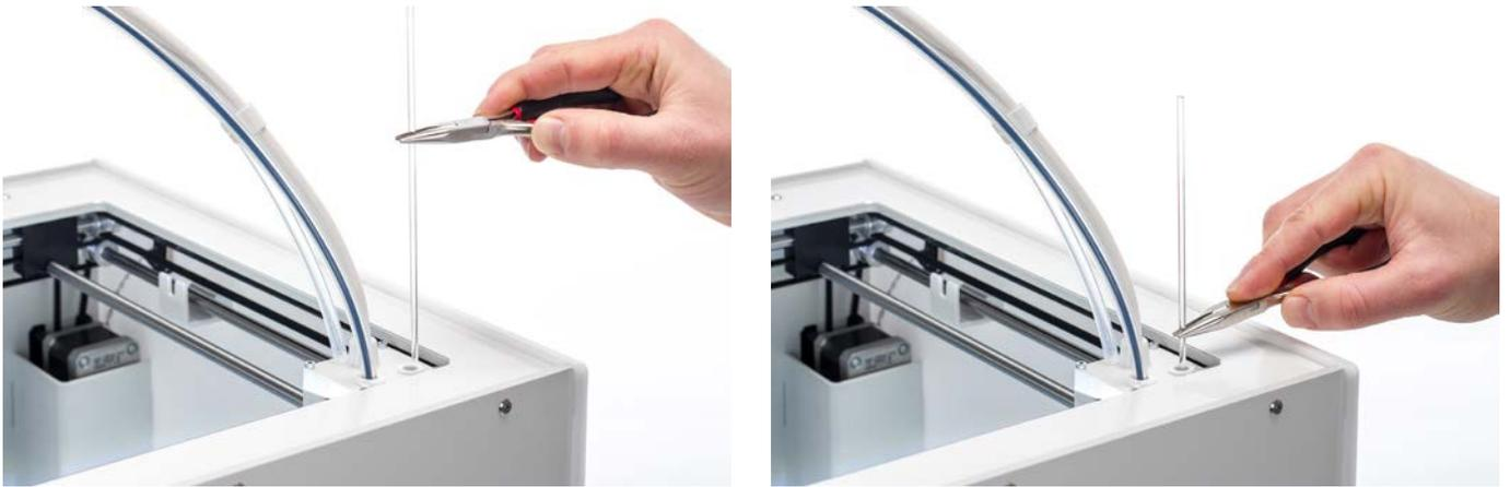
3. 剪掉剛剛拔出的線材尖端。
