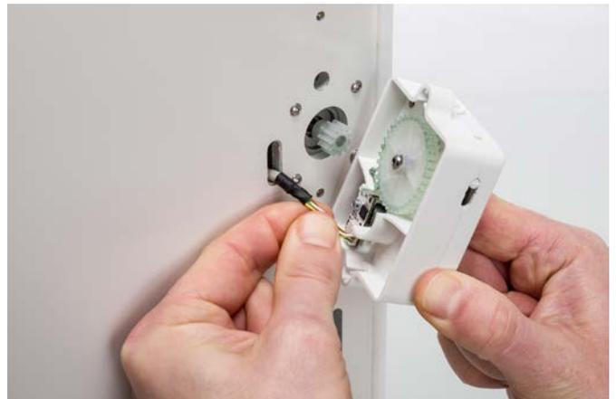
5. 使用乾淨的布或棉簽擦去進料器齒輪上的所有線材碎粒和油脂殘留物。清潔進料器內連接到電動機的齒輪和較大齒輪。
