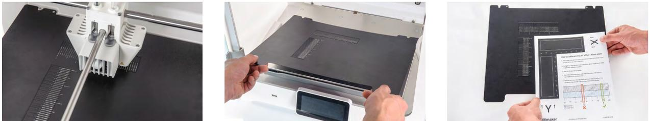
**i** Coloque la hoja de calibración XY junto a la placa flexible como referencia. Esto muestra cuál de las cuadrículas corresponde a X e Y e indica los números de las líneas impresas.
